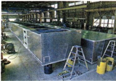
製作中の高さ4.5m、幅20mの水門陸間
