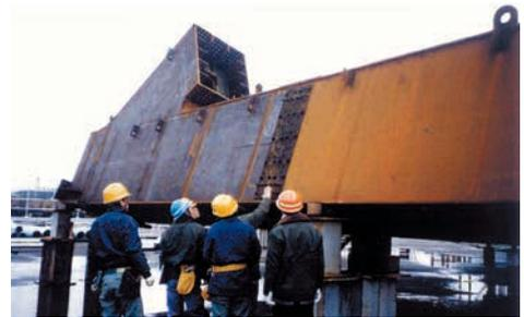
新開発法(プレコート処理あり:左)と従来法(プレコート処理なし:右)の比較
